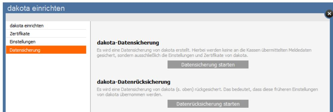
Über die Schaltfläche ‚Datensicherung starten‘ erstellen Sie die Sicherungsdatei. Wählen Sie im Sicherungsassistenten über die Schaltfläche ‚Durchsuchen‘ den Ordner ‚Dateitransfer‘. Im angegebenen Pfad wird der Ordner ‚dakota\_s‘ erstellt, der nun eine Datei mit der Endung ‚.dag‘ enthält.
